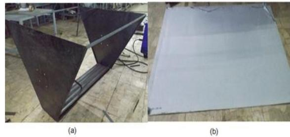
Gambar 3. (a) Reflektor plat datar AISI 1015, (b) Reflektor plat datar SS 201
